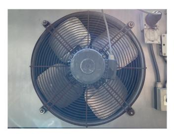
Antriebstechnik 3~Mot. 80S G. Bauknecht AG 3379562-272 55/4-7 B14 cos⊈ 0,78 n 380/220 V 5/3,2 A 1410 minkW 0 IP54 Isol.Kl. B 50 17 VDE 0530/84 715070 E06
